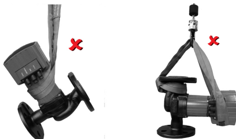
Abb. 2: Falscher Transport der Pumpe
